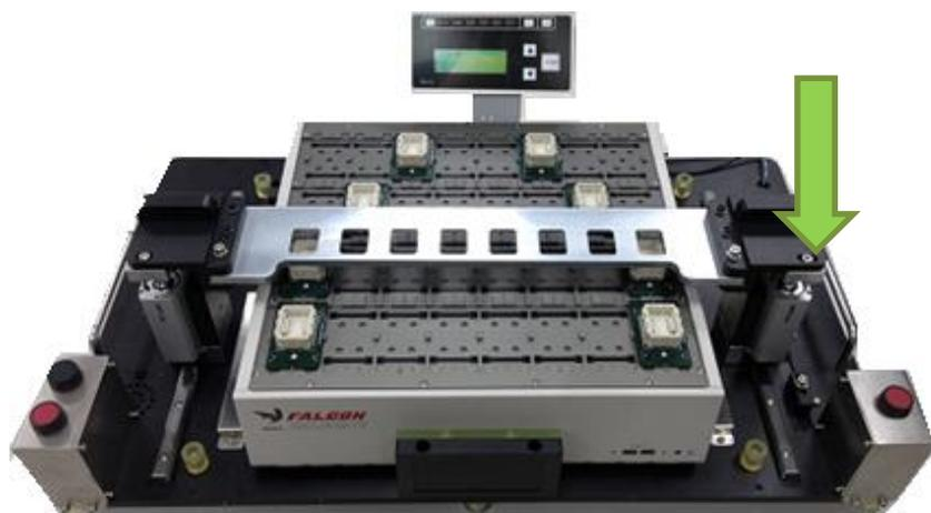
本装置はエアの圧力を利用してアダプタのソケットの開閉を行います
